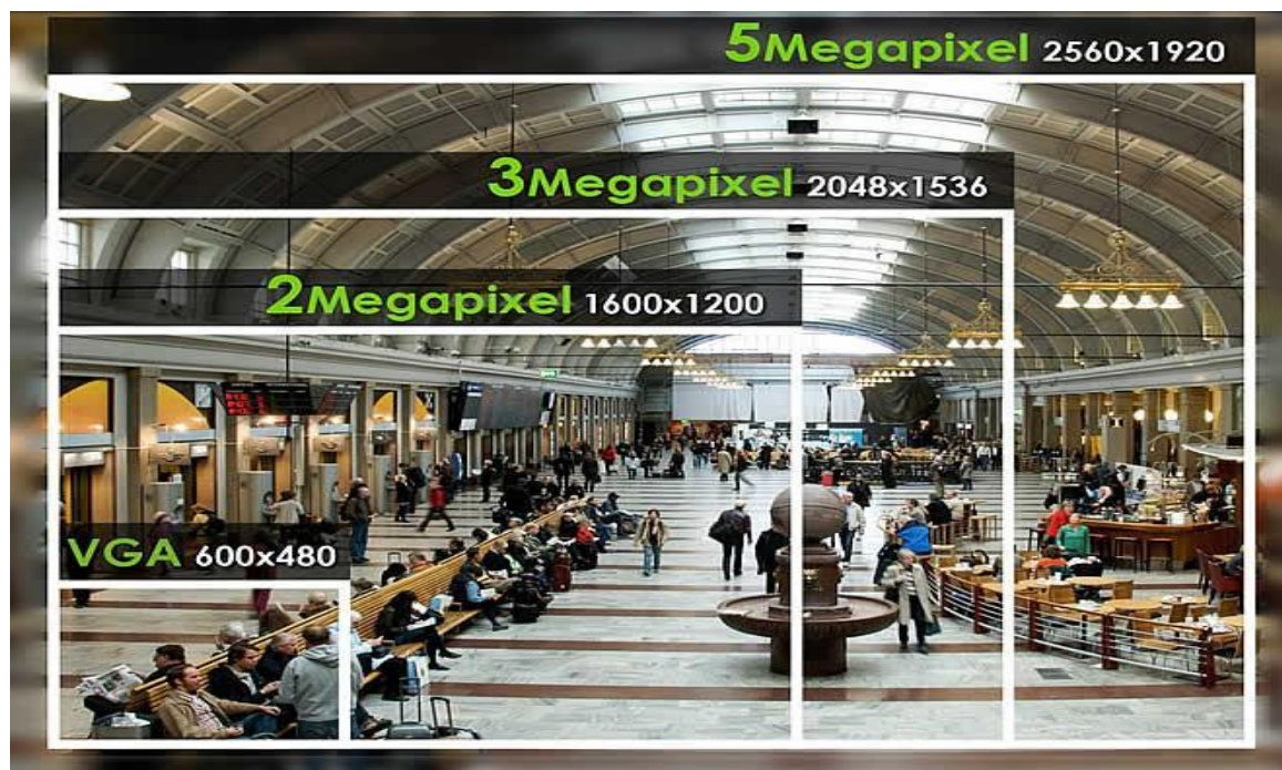
Figura 2. Acoperirea asigurata de camere in functie de rezolutie
